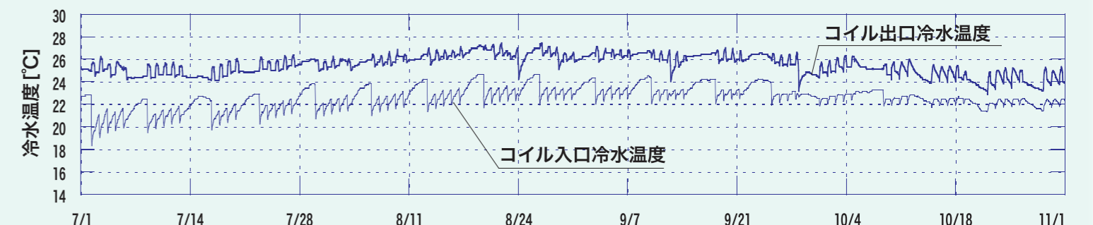
図-10 三年目のコイル出入口冷水温度の実測値
