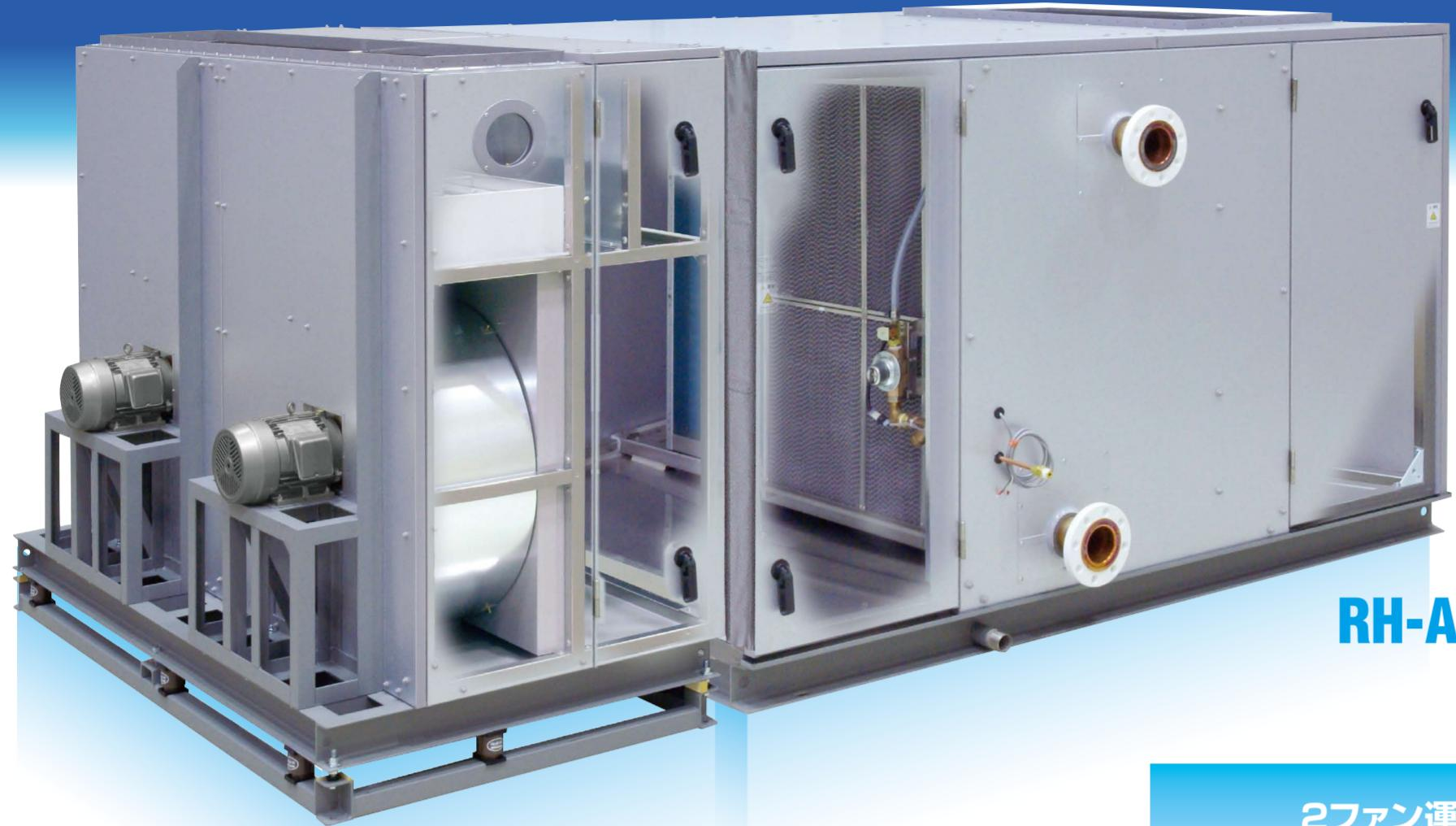
R型リリーフエアAHUは、1台の空気調和機に2台のファンモータを搭載している。ファンはリミットロード特性を有したプラグファンを用い、それぞれのファン吐出口に自力式ダンパを設置することにより、2ファン運転と1ファン運転の切替えを自動的に行えるような特長を備えている。また、1台のみのファンモータ運転時には、圧力損失を大幅に下げるため、2台運転時の50%の動力で風量約70%・冷房能力約80%を確保できることも特長の1つである。
