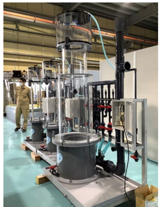
写真 8. プロテインスキマー外観
