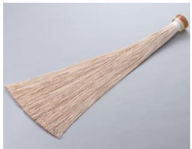
図5 膜モジュール 片側フリー構造
