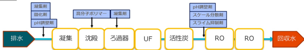
図3 従来の排水回収システムのフロー概要
